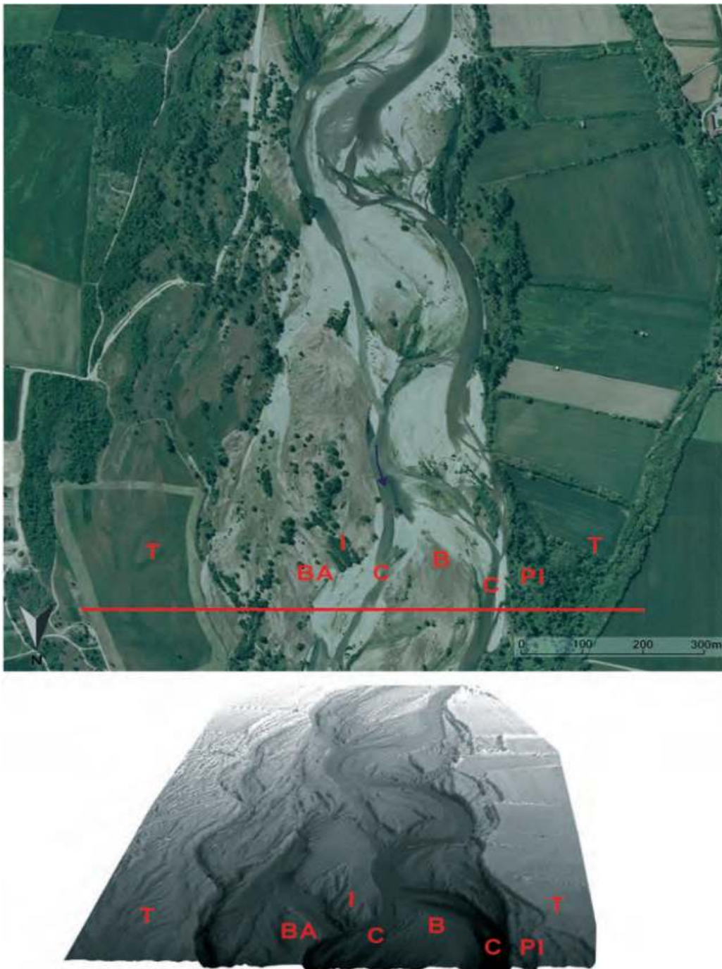
Figura 2.4: Modello digitale dell'alveo (DEM ottenuto da dati LiDAR) e foto aerea di un alveo a canali intrecciati, con indicazione delle varie superfici morfologiche presenti: C: canale; B: barra; BA: barra alta; I: isola; PI: piana inondabile; T: terrazzo. La freccia blu indica la direzione della corrente [37].
