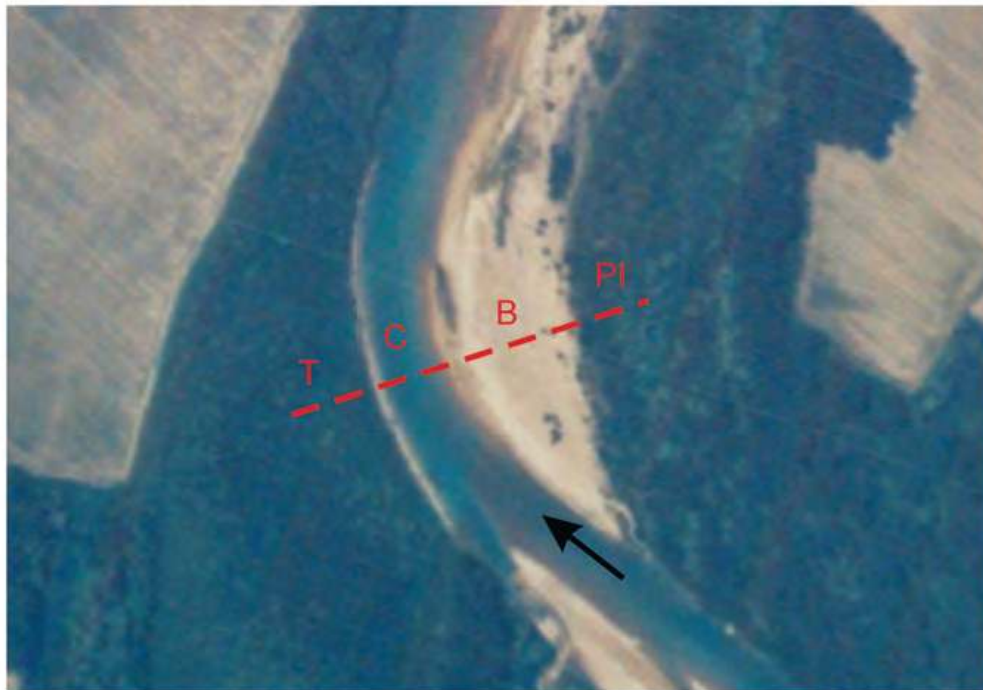
Figura 2.3: Sezione trasversale di un alveo a canale singolo (sinuoso) con indicazione delle varie superfici morfologiche presenti. C: canale; B: barra; PI: piana inondabile; T: terrazzo. La sezione è indicata con un tratteggio rosso sulla foto aerea, mentre la freccia nera indica la direzione della corrente [37]).
