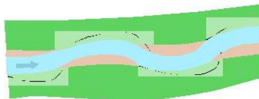
Figura 3.8: Taglio selettivo della vegetazione a portamento arboreo nelle sole aree che si valuta possano essere erose nel corso delle prossime piene. \ Evoluzione planimetrica attesa dell'alveo attivo. ■ Aree di possibile erosione durante le piene
