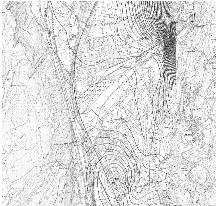
Fig. 10: Freatimetria nella zona della Foce Avisio, sono bene evidenti le depressioni legate ai campi pozzi.
