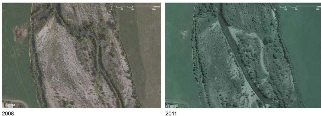
*Fig. 23: Esempio di demolizione di fasce di vegetazione arborea lungo il canale attivo a seguito del repentino cambio di tracciato dello stesso. La subitanità dello spostamento è testimoniata dall'integrità della copertura vegetale, anche arborea, tra vecchia e nuova posizione del canale.*
